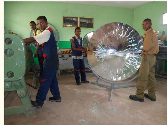
Montage von Solarkochern erfordert viele Fertigkeiten
